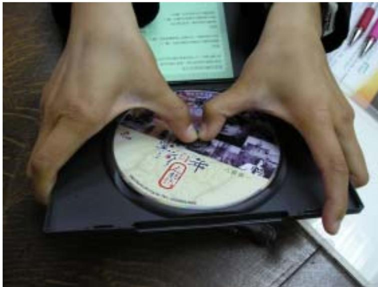
正確光碟拿取方式：利用大拇指壓取光碟中心處，即可取下光碟。
