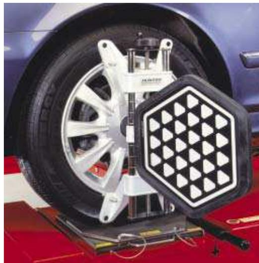
※ 僅可以使用手來鎖緊中間滑塊固定把手，不可以使用任何工具來鎖緊夾具固定把手。
