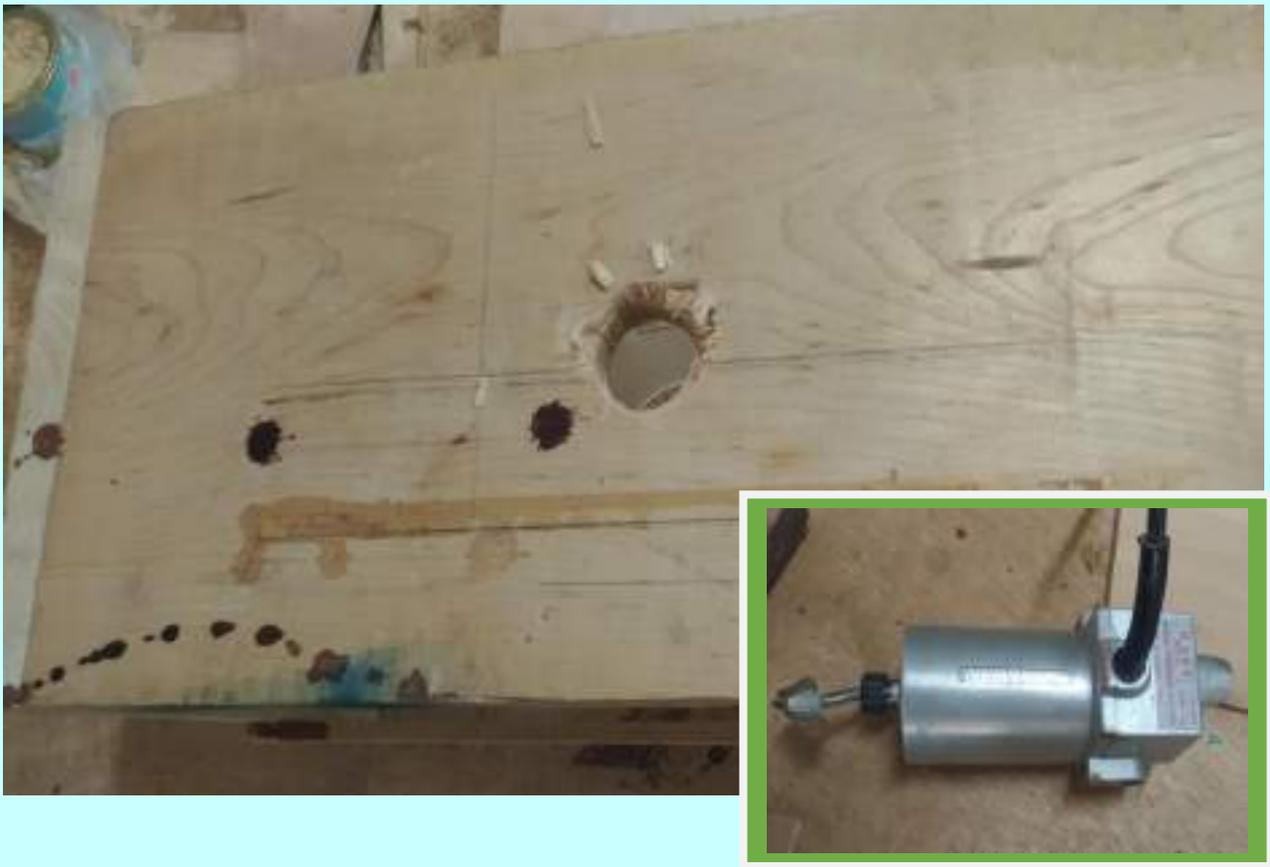
廣告設計科徐○○老師以手持式修邊機器進行木製支撐架木板孔洞擴孔作業時，修邊機切削木料產生之反作用力造成修邊機彈起，徐員未握緊修邊機致遭修邊機高速旋轉刀刃割(削)傷
