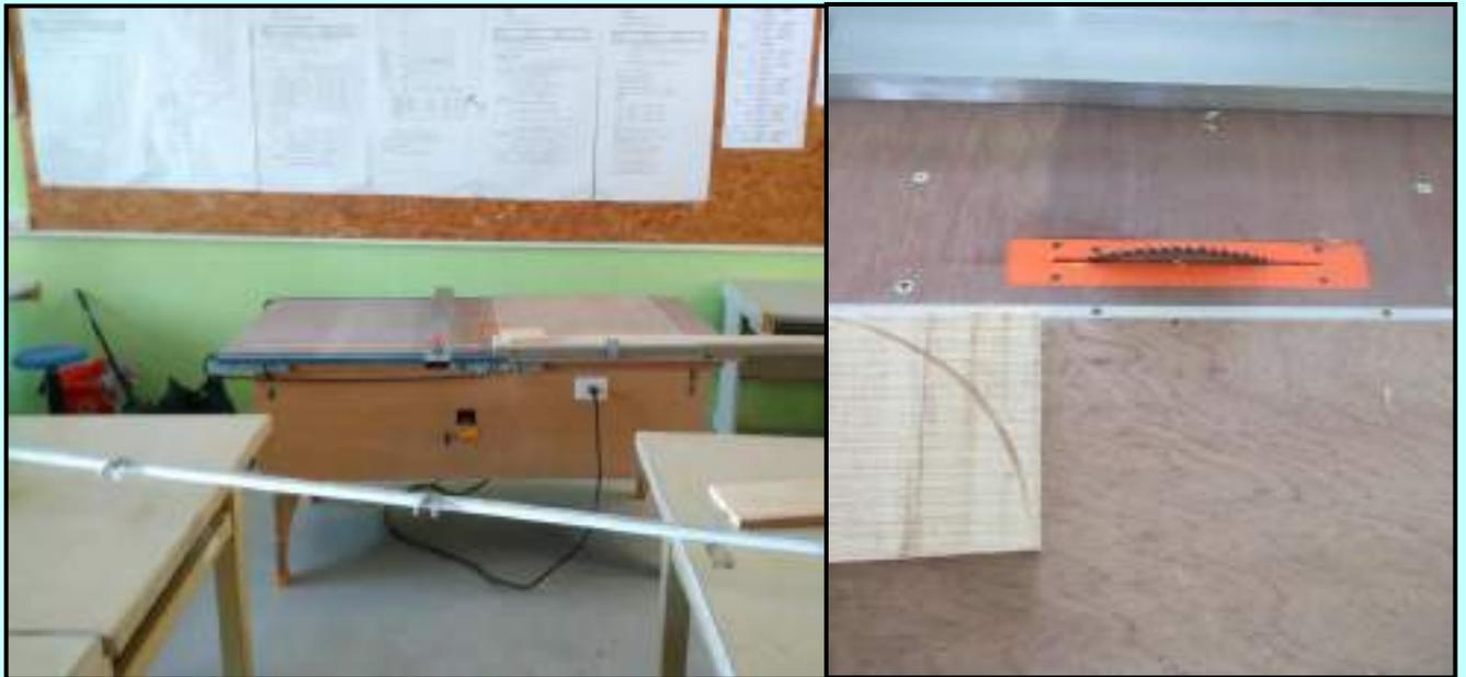
所使用木材加工用圓盤鋸未設置反撥預防裝置及鋸齒接觸預防裝置
